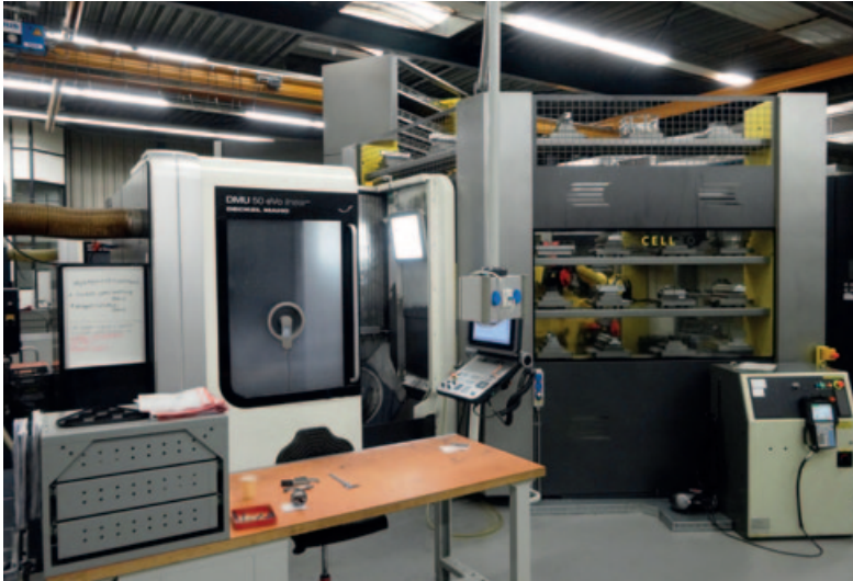
De geautomatiseerde afdeling stelt KMWE in staat om een diverse mix van werkstukken door elkaar heen te bewerken. De productiecel bestaat uit een DMU 50 bewerkingscentrum aangesloten op een automatiseringscel van Cellro
