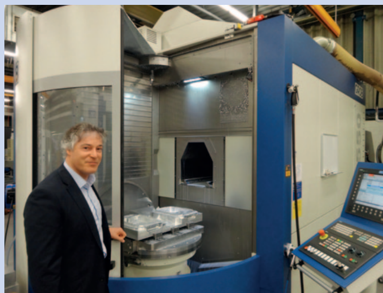
De Grob G550 wordt bij KMWE ingezet voor hogesnelheidsverspanen. De bouwwijze van de Grob is volgens Van Bakel een belangrijk voordeel voor snel en diep kamerfrezen
