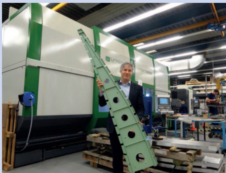
Grignon van Bakel met een aluminium rib voor de flap van de Airbus A380. Het produceren van luchtvaartgerelateerde constructies is een belangrijke tak van sport binnen KMWE. Op de achtergrond een bewerkingscentrum van Unisign (foto's: Tim Wentink)
