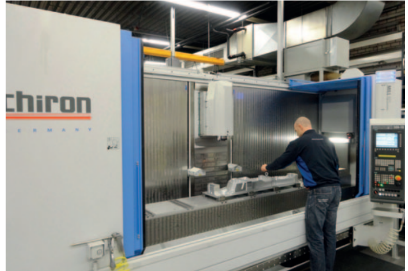
KMWE investeert in een modern machinepark om een hoge kwaliteit te waarborgen. Op de foto een aluminium werkstuk die verspaand is met een bewerkingscentrum van Chiron
