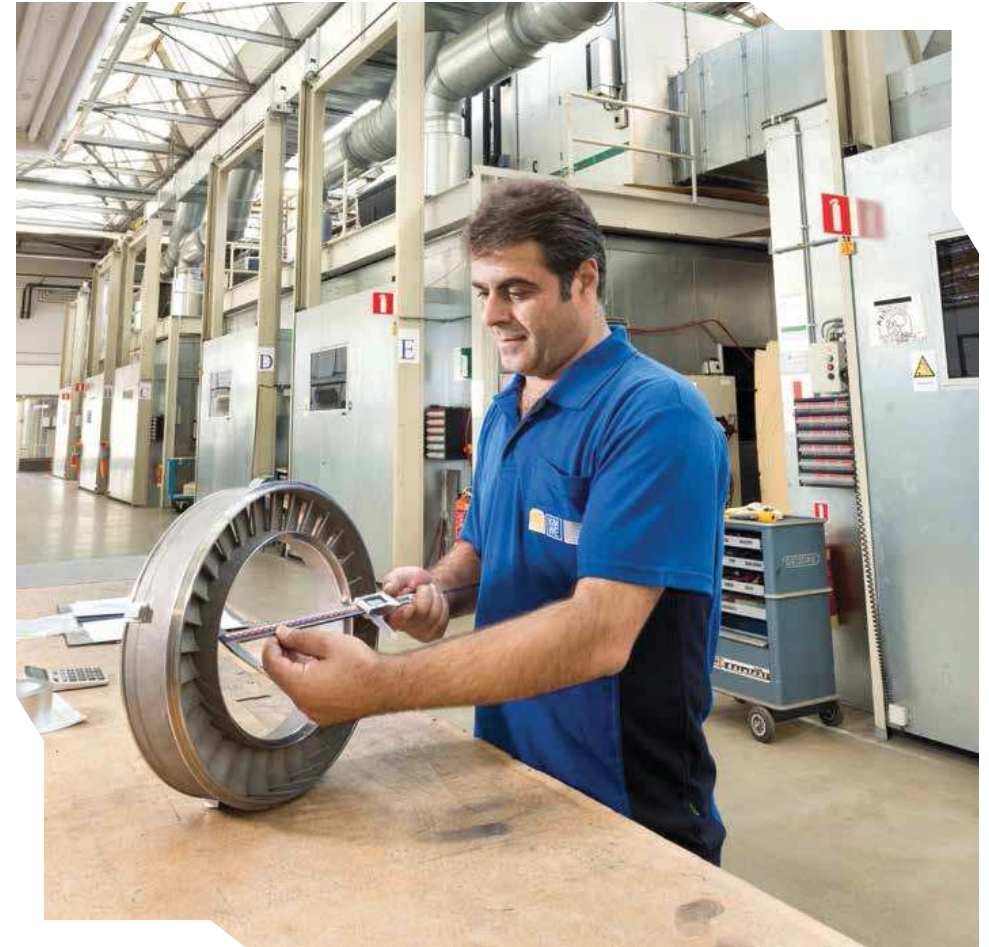
Een medewerker van DutchAero-Thermal Spray meet een product. Op de achtergrond zijn de spuitcabines voor het thermisch spuiten te zien.
